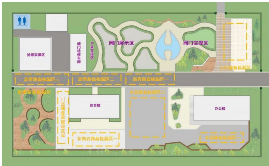
图 4 供水管网漏水探测场地示意图
