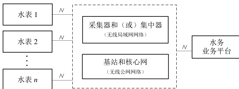
图B.2 无线远传自动抄表系统结构示意图
